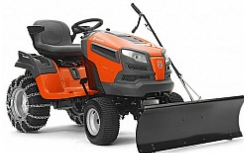
При работе в зимнее время на колеса трактора необходимо устанавливать цепи!
